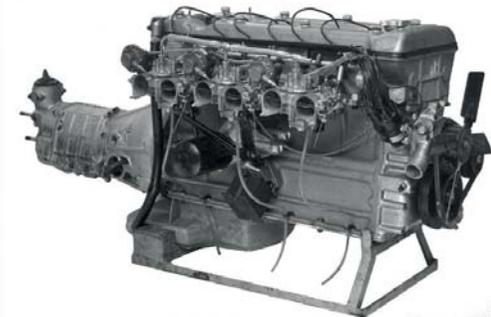
Die Fotos oben zeigen den neu entwickelten Sechszylinder-Motor 1957 auf dem Alfa-Romeo-Prüfstand.
