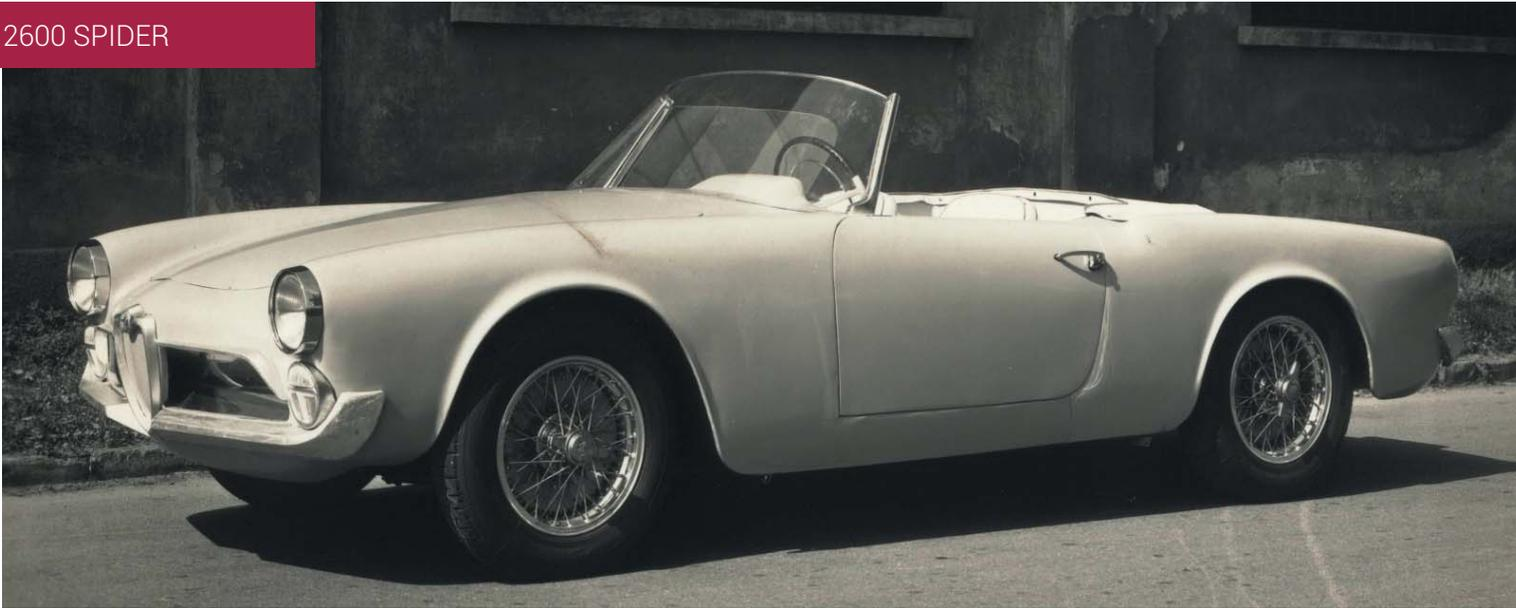
Das Dach hatte eine flachere Linie als beim späteren 2600, die Kofferraumhaube war stärker nach hinten abfallend. Ein erster Prototyp hatte noch keine Lufthutze in der Motorhaube, in einer zweiten Version wurde die Öffnung eingefügt.
