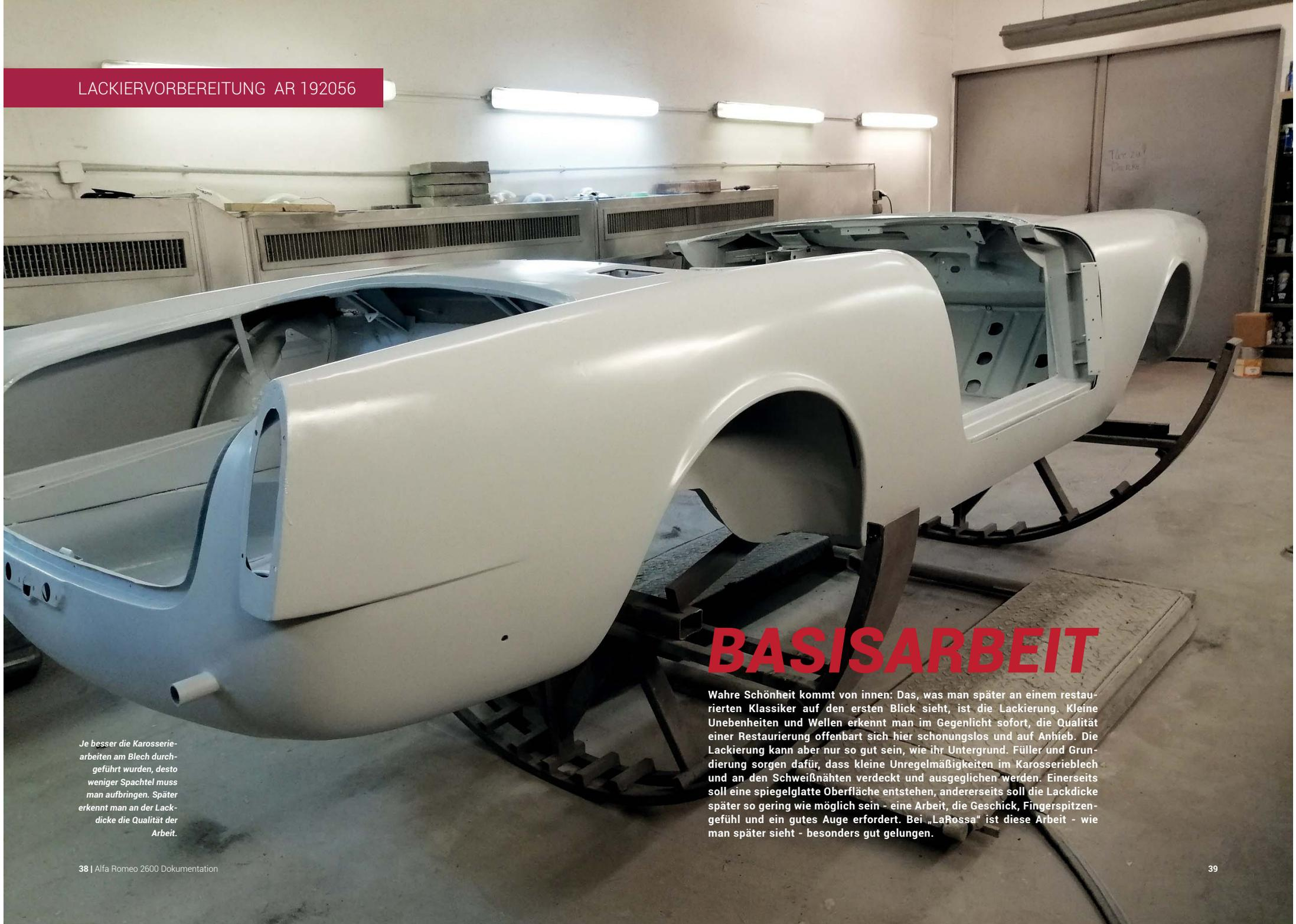
*Je besser die Karosseriearbeiten am Blech durchgeführt wurden, desto weniger Spachtel muss man aufbringen. Später erkennt man an der Lackdicke die Qualität der Arbeit.*
