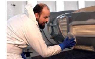
Eine professionelle Lackierkammer muss über die starke Absauganlage im Boden möglichst absolut staubfrei sein. Nach der Lackiervorbereitung wird die Karosserie gründlich gereinigt, dann die Farbe gefiltert um jegliche Verunreinigungen zu vermeiden. Schließlich werden erst die schwierigen Ecken und Kanten lackiert, damit auch hier die Farbe überall deckt. Erst dann wird die Fläche gesprüht - Michelangelo lackiert vier hauchdünne Schichten nass in nass.
