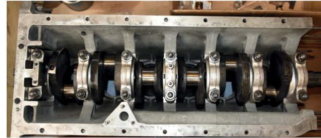
*Absolut ärgerlich: Anstatt der im Motordichtsatz enthaltenen Gummiringe (unten) zur Abdichtung der kleinen Ölkanäle zum Zylinderkopf, hatte die deutsche Firma eine Dichtmasse da reingeschmiert. Das konnte nicht halten - Ergebnis: Ölaustritt an der Dichtung*
